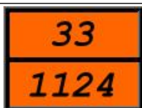
Pannello dei codici di pericolo
